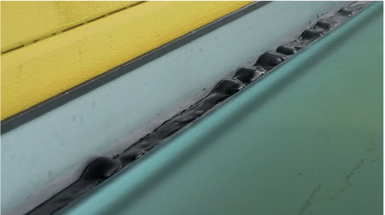
Schadenfall: Blasenbildung/Verwerfung welche durch ungeeignete Hinterfüllmaterialien, zu kurze Wartezeiten nach dem Hinterfüllen, oder durch zu hohe Temperaturen während der Versiegelung entstehen können.
